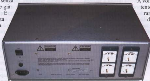
Il posteriore con le quattro robuste prese Schuko.
